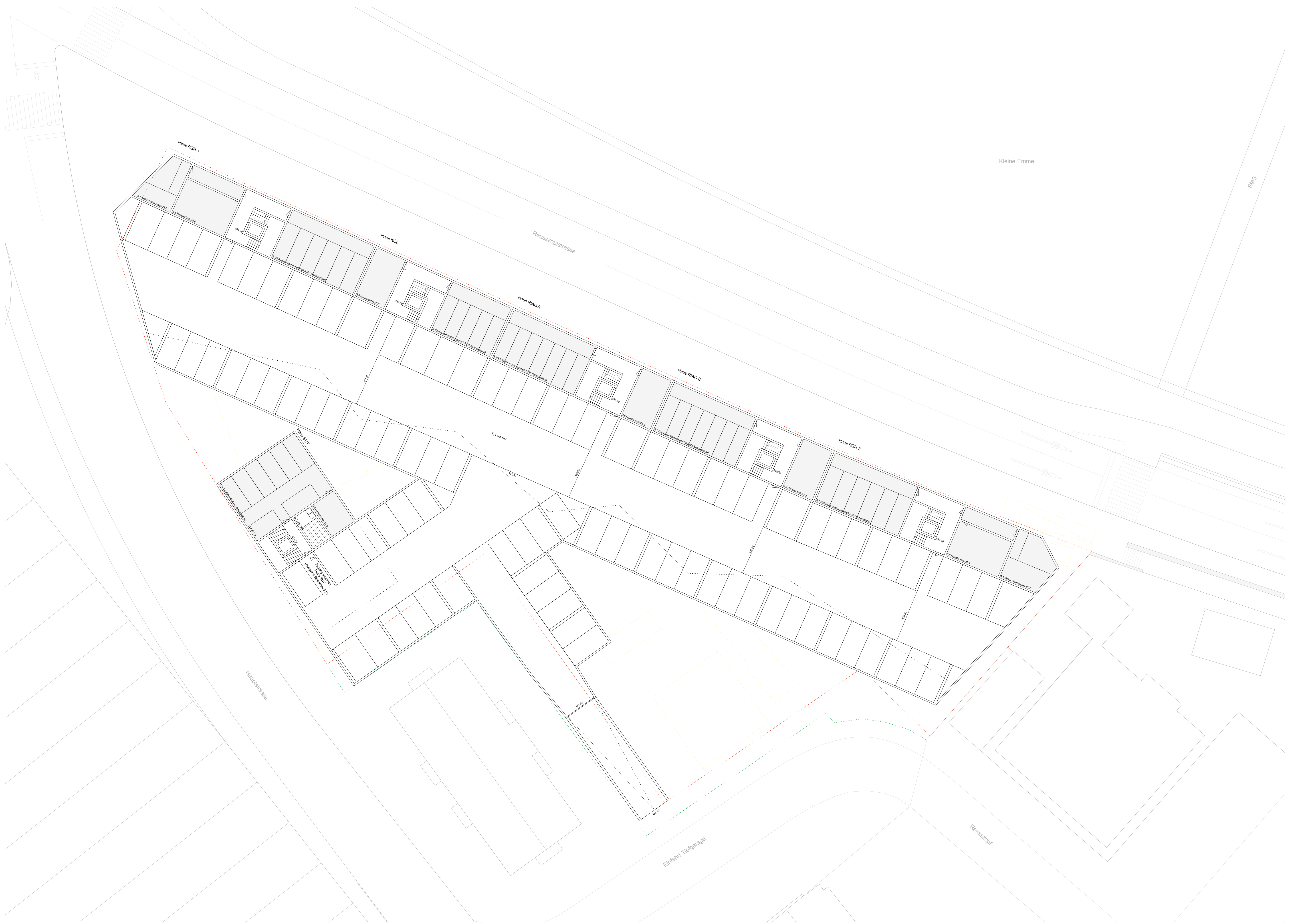
Grundriss 2.Untergeschoss, Tiefgarage, 1:200
